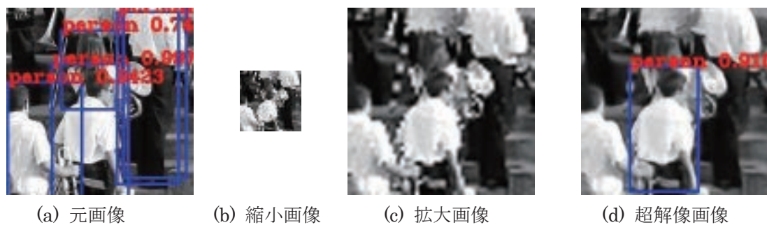
Fig.26 超解像による物体検出結果
