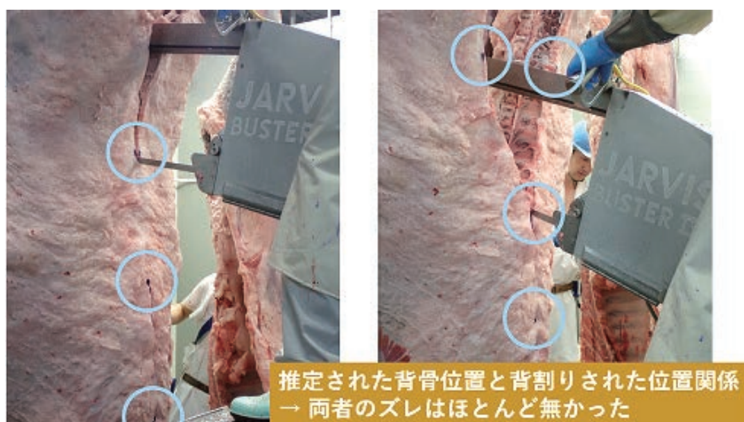
図5 墨付けした背骨推定位置と実際に背割りした位置との比較
